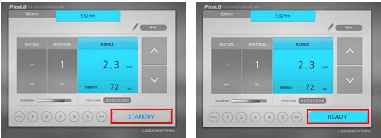
10. Presionar el interruptor de pedal para operar la emisión láser después de apuntar una pieza de mano a un papel para quemar. Asegúrese de que el rayo de referencia esté alineado visualmente con el rayo láser.
