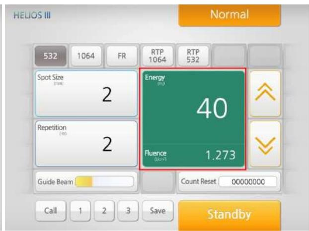
7. Seleccionar el modo de haz guía y luego ajustarlo tocando el botón up/down (arriba/abajo).
