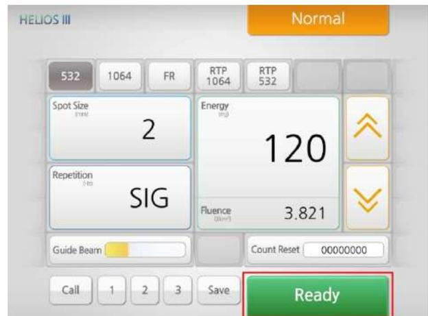
10. Presionar el interruptor de pedal para operar la emisión láser después de apuntar una pieza de mano a un papel para quemar. Asegúrese de que el rayo de referencia esté alineado visualmente con el rayo láser.
