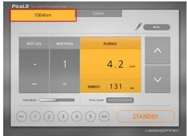
3. Seleccionar el modo repetición y ajustar para individual, M3, M5, 1~10Hz con el botón up/down (arriba/abajo).
