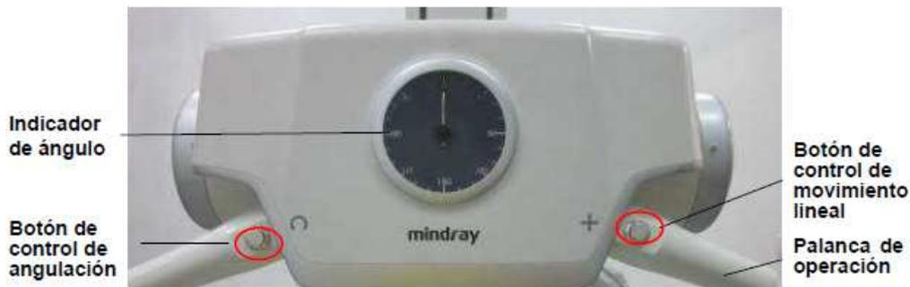
Para rotar el conjunto del tubo-colimador en el plano vertical, presione el botón de control de angulación en la palanca izquierda de operación. Para mover el conjunto verticalmente a través del soporte del tubo o lateralmente a lo largo del riel de piso, presione el botón de control de movimiento lateral en la palanca derecha de operación.
