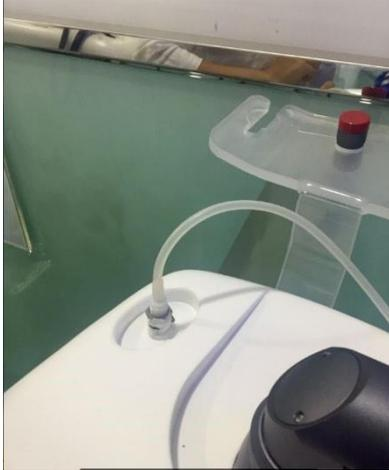
Nota: preste más atención en el cable USB y el tubo de soplado, evite 90 grados de ángulo muerto y asegure un movimiento fácil de 360 grados.
