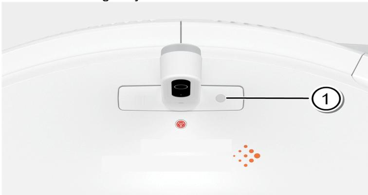
(1 ) Indicador de rayos X en la FAST3D Camera integrada en el gantry
