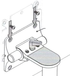
Coloque los tornillos M4 en los dos orificios superiores del soporte de fijación del monitor.
