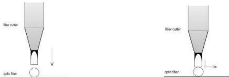
Paso 1: apoyar la cortadora de fibra en posición perpendicular a la fibra.
