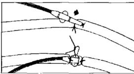
Asegúrese de que no hay sangre en el fiador y de que éste se limpia. La sangre coagulada puede repercutir en la movilidad del fiador en la sonda. En el envase de plástico inferior se encuentra un fiador de recambio.
