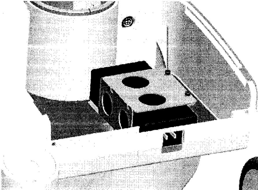
Para abastecer de energía al sistema **MylabTouch** cuando está instalado en el carrito, se utiliza el mismo adaptador de CC que para el **MylabTouch** en modo de funcionamiento normal. Abra la tapa de la base del carrito, coloque el adaptador de CC en el centro e instale el soporte que se utiliza para que el adaptador no se mueva de posición. A continuación, conecte el adaptador de CC en la toma situada dentro de la base. Por último, conecte el cable de alimentación en el adaptador.
