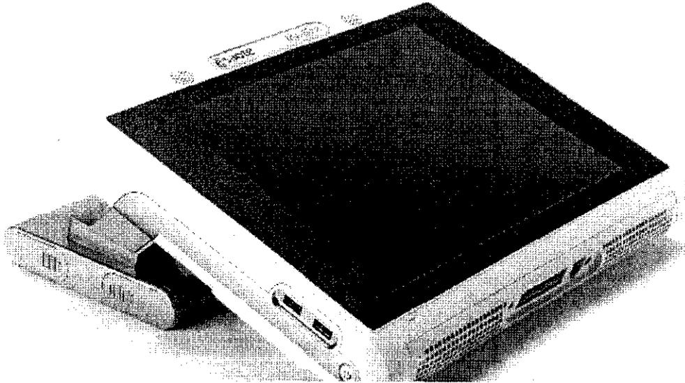
*Atención: Extraer el polvo y la suciedad que se haya podido acumular en los orificios de ventilación del sistema con una aspiradora de poca potencia.*
