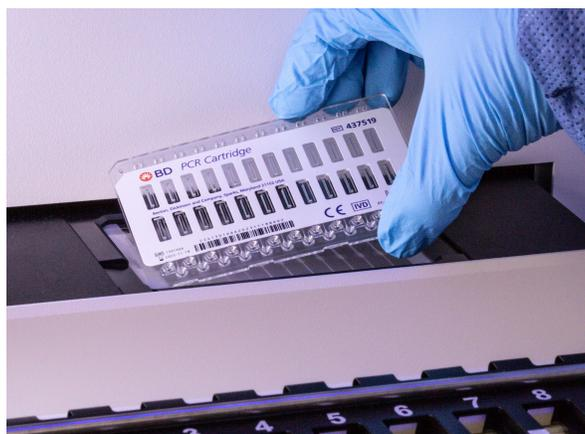
**Figura 2:** Carga de las tarjetas de PCR BD
