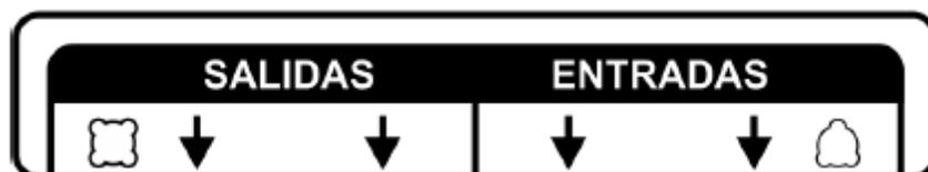
**Indicación de conectores hidráulicos de entrada y salida**
