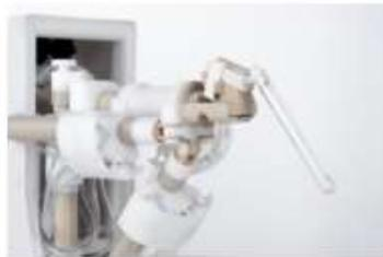
6- Pulse el botón 3 para fijar el robot en la placa de mesa, la altura y la guía de la aguja con el soporte.
