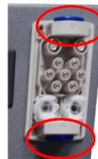
3. Conecte el conector del aplicador de mano al dispositivo.
