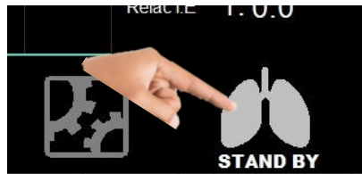
Figura 30. Ventilando, presione para detener la ventilación
