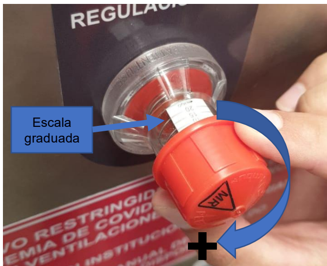
Figura 20. Regulación de la presión PEEP
