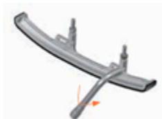
3. Coloque el riel de balancín TrueLok con la marca **FRONTAL** en la placa para los pies insertando sus varillas de fijación en los agujeros apropiados.
