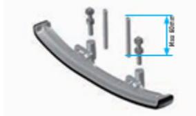
9. Si se necesitan varillas roscadas de más de 60 mm, fortalezca la construcción con los kits de extensión de riel de balancín. No utilice varillas roscadas de más de 115 mm. En caso de que se necesite una extensión mayor, considere agregar una plataforma adicional.
