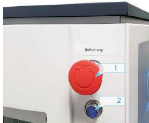
Figura 3.4.8 Interruptor de parada de movimiento y conector para el control manual
