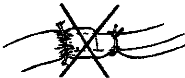
Figura 7. No apretar excesivamente las suturas y no atar una sutura al cuerpo del cable.
