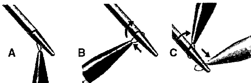
Figura 3: Extracción del lazo de asociación
