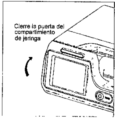
FIGURA 3.2.3.1-7: Cierre del compartimiento de la jeringa en el modelo MP-30.
