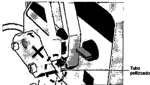
Fig 15. Ejemplo de posición incorrecta con el tubo pellizcado
