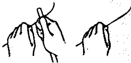
Figura 20. Modo de curvar el cable con un objeto liso
