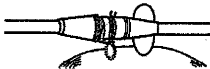
Figura 23. Manguito ranurado de fijación de triple surco afianzado al cable y a la fascia mediante dos surcos
