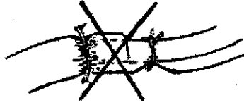
Figura 24. NO atar las suturas demasiado apretadas y NO atar una sutura al cuerpo del cable
