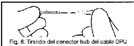
Fig. 6. Tirando del conector hub del cable DPU
