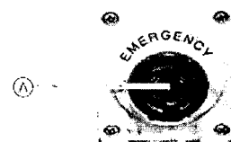
Figura 5-1: Botón de apagado de emergencia del sistema
