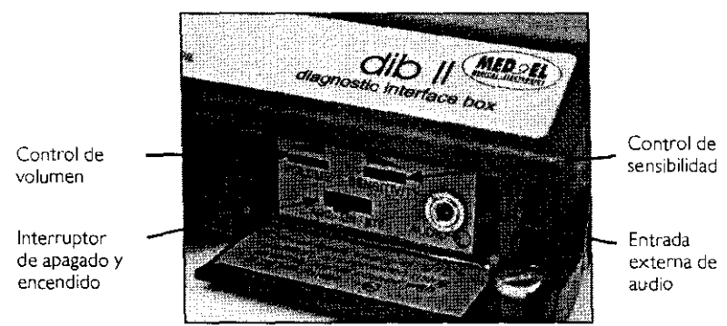
Fig. 2 Frente del DIB II, a la derecha bajo la tapa
