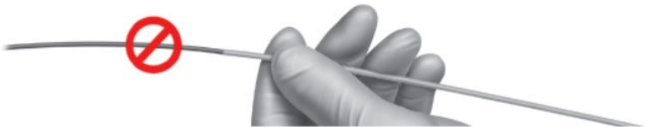
Figura 7: Sujete la vaina estabilizadora. NO sujete ni toque la vaina móvil oscura.
