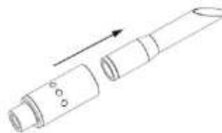
Separación de la parte aplicada de la punta
