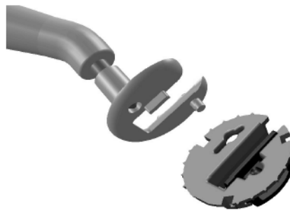
Figura 11. Fijar el seguro de sujeción al extremo en U de la herramienta
