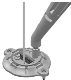
Figura 12. Coloque con cuidado el seguro de sujeción sobre la base.
