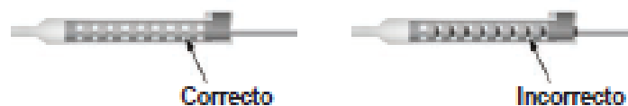
Figura 21. Alineación del electrodo de ECP en el conector de extensión de electrodo
