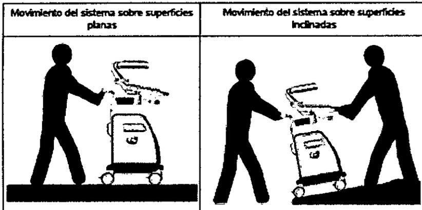
El Voluson® P6/P8 pesa aproximadamente 70 kg, dependiendo de los periféricos instalados, (aprox. 154 lbs. o menos) cuando se encuentra preparado para el uso. Debe tenerse cuidado al mover o sustituir sus elementos. De no seguir las precauciones enumeradas podrían producirse lesiones, movimientos incontrolados y daños costosos.
