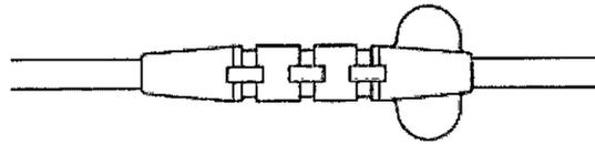
*Figura 13. Manguito ranurado de fijación de triple surco con lengüetas*
