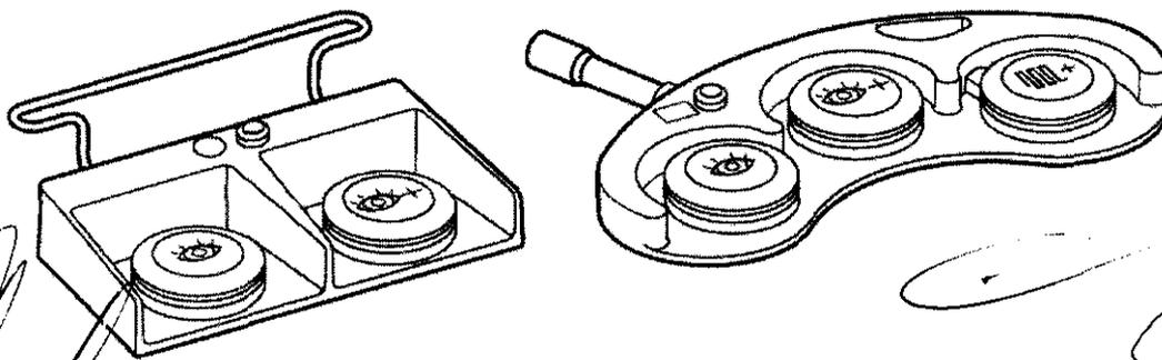
Ilustración 3-5. Interruptores de pie de dos y de tres pedales.
