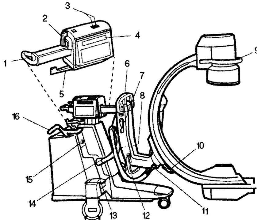
Ilustración 4-2. Identificación de componentes para arcos móviles
