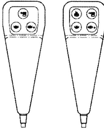
Ilustración 3-6. Interruptor manual de tres y cuatro botones.
