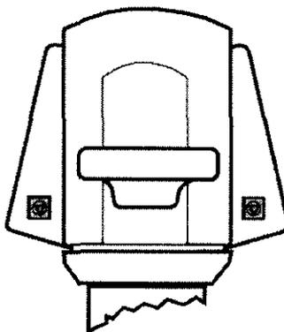
Ilustración 3-3. Los interruptores de parada rápida se encuentran en cada panel de control del arco móvil.
