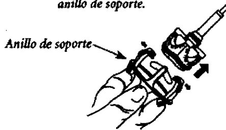
Figura 4: Para liberar el soporte de la válvula del anillo de sutura, oprima las tres lengüetas en la base del soporte de la válvula, debajo del anillo de soporte.
