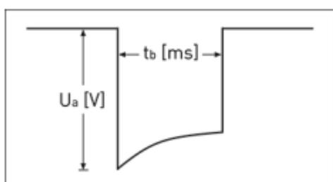
La amplitud de impulso alcanza su valor máximo al inicio del impulso ( $U_a$ ). Con una duración de la estimulación ( $t_b$ ) en aumento se reduce la amplitud en función de la impedancia de estimulación.
