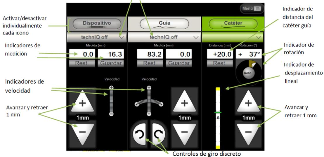
Figura 3-3: Controles de la consola de control y la pantalla táctil
