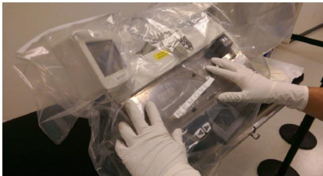
Figura 8-6: Alineación de la placa frontal con los salientes de la unidad robótica
