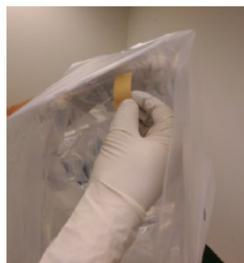
Figura 8-4: Retire el dorso de las pestañas adhesivas situadas sobre la placa frontal
