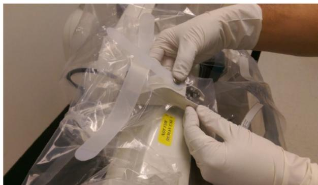
Figura 8-7: Colocación de la cobertura sobre la abrazadera del carril
