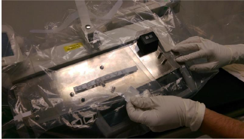
Figura 8-8: Extracción de la cubierta de la placa frontal provisional
