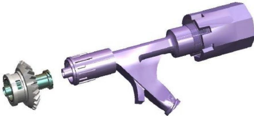
Figura 8-10: Unión del engranaje de transmisión y el conector en Y
