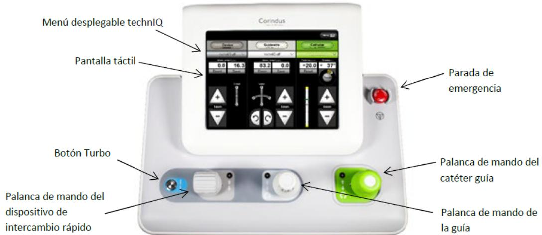
Figura 3-1: Vista superior de la consola de control
