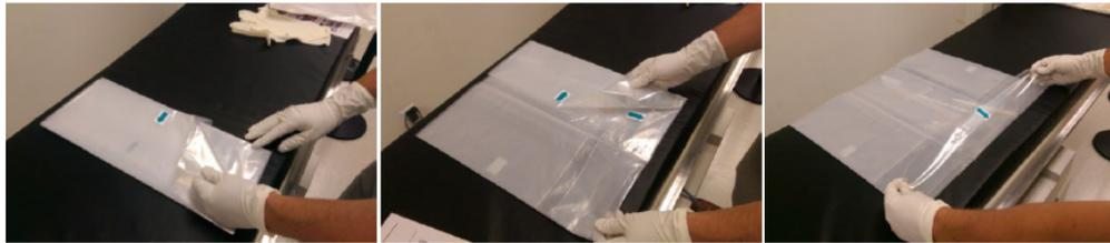
Figura 8-2: Despliegue de la cobertura
