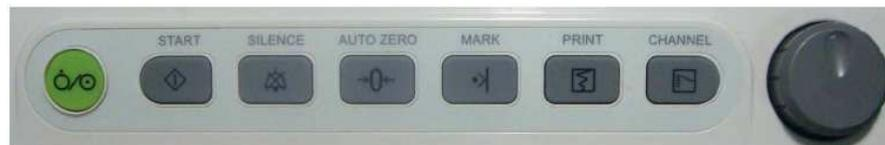
De izquierda a derecha se encuentran los botones de: encendido, inicio de monitoreo/regreso a interfaz principal, silencio (apagado de alarma), calibración de cero del transductor de TOCO, marca de evento, comienzo/detención de impresión, canal (alterna entre canal1 y 2 de ultrasonido) y perilla de comando/navegación
