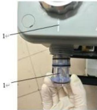
2. Alinee el sensor de caudal con la ranura e insértelo horizontalmente.
