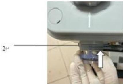
3. La ranura de la articulación respiratoria está alineada con la ranura superior e inferior del sensor de caudal, como se muestra en la figura.
