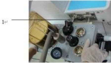
2. Empuje el sistema del circuito respiratorio en el adaptador del circuito haciendo fuerza, de manera que el sistema del circuito respiratorio esté conectado al adaptador del circuito sin espacios. Verifique que el sistema del circuito respiratorio esté bloqueado.
