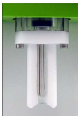
Figura 15: tubo de muestras insertado para asegurar los componentes del acoplamiento para muestras
