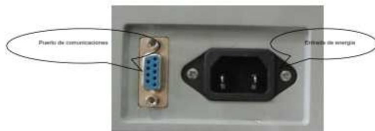
Figura 5.6 Toma de corriente
