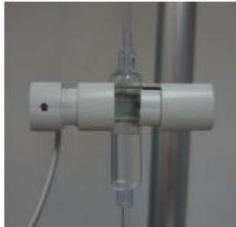
*Nota λ Después de la instalación del tubo de infusión, por favor ajuste bien el tubo de infusión para asegurar que no se doble o deforme. λ Asegúrese de que el clip de goteo esté derecho, de lo contrario, las señales de goteo no pueden ser detectadas o el equipo lo considerará como una situación anormal con una alarma de sonido y luz.*
