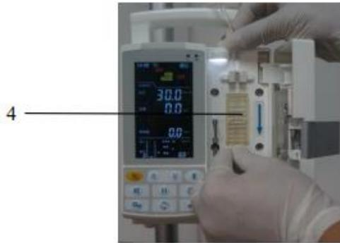
5. Coloque el tubo de infusión para que se apegue al panel del tubo de infusión, como se muestra en la figura.
