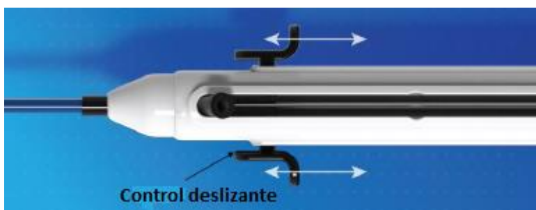
Figura 6. Comprobación de bloqueo/desbloqueo y avance/retroceso del control deslizante (corredera)
