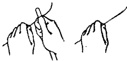
Figura 4. Modo de curvar el cable con un objeto liso
