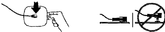
Figura 9 Conexión de electrodos FAST-PATCH al cable de desfibrilación
