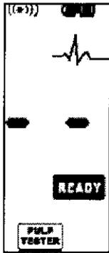
3. Cambie al modo "test pulpar", presionando el botón "MODE SWITCH". Aparecerá en la pantalla la etiqueta de "PULP TESTER" y luego "READY"; esto indica que el test pulpar está en condiciones de ser utilizado. (Fig. 19)
