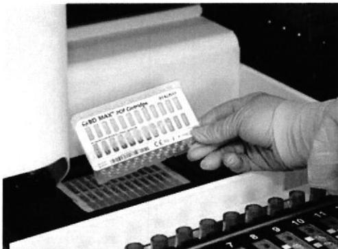
Figura 2: Carga de las tarjetas de PCR BD MAX™
