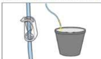
(Fig. 10) Cierre de la pinza de la línea de drenaje.
