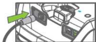
(Fig. 6) Conexión del cable al generador.
