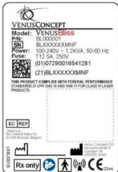
Figura 2-2: Etiqueta de identificación del sistema
