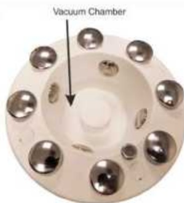
Figura 7-1: Cámara de vacío del aplicador (MP)²
