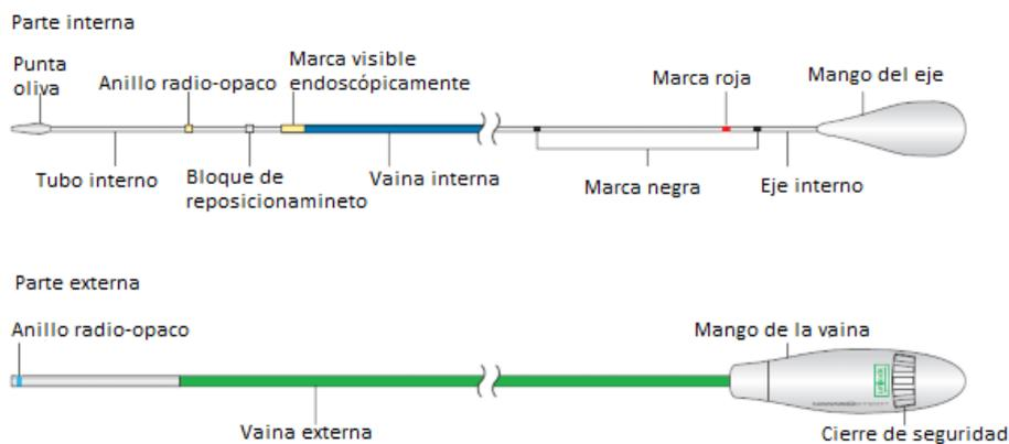
1-El sistema de liberación está compuesto por una punta oliva, un anillo radiopaco (utilizado en la aplicación endoscópica), un bloque de reposicionamiento, una vaina externa, una vaina interna, un mango de la vaina, una marca roja, dos marcas negras, un eje interno, un tubo interno, un mango del eje y un cierre de seguridad.
