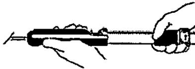
15. Elevándola completamente recta, dé la vuelta por completo a la palanca de liberación de la vaina introductora hasta que haga clic cuando quede en su lugar junto a la válvula de retención.
