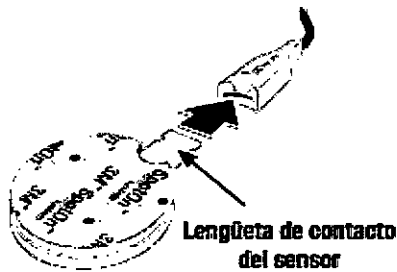
Figura 2-5: Conecte el sensor al cable de sensor
