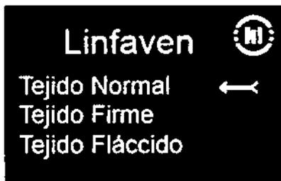
Utilizando las teclas UP o DOWN se puede seleccionar el programa según el tipo de tejido de la zona a tratar. Una vez que el cursor se posiciona en el modo deseado, presionar ENTER para iniciar la sesión. Si se presiona la tecla ESCAPE se retrocede al menú de selección de modo.
