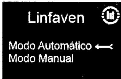
Utilizando las teclas UP o DOWN se puede seleccionar el Modo Automático o Modo Manual. Una vez que el cursor se posiciona en el modo deseado, presionar ENTER para aceptar.
