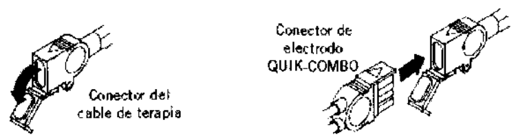
Figura Conexión de los electrodos QUIK-COMBO al cable de terapia
