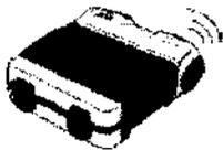
2 Pulse el botón de **ENCENDIDO/APAGADO** para encender el desfibrilador (se ilumina el LED verde). De este modo se escucharán mensajes audibles que le guían por el proceso de rescate.
